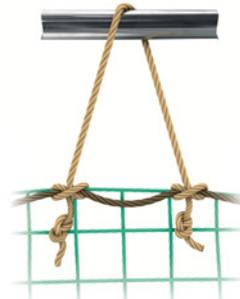
Seile sind gegen Aufdrehen zu sichern und dürfen durch scharfe Kanten nicht beschädigt werden können. 4
