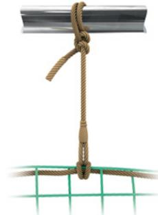
Netzaufhängung durch Umschlingen und Verknöten des Aufhängegeseiles am Trageelement.
